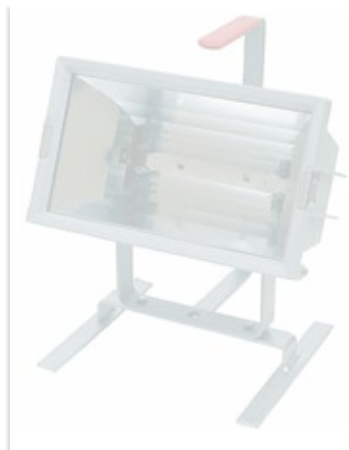
Bodenständer, groß in stabiler, feuerverzinkter Aus- führung für Halogenstrahler verschiedener Größe und Ausführung bis 1500 W. Der Bodenständer ist rutschfest durch Gummifüße und hat einen isolierten Handgriff. Mit Befestigungsschrauben.
