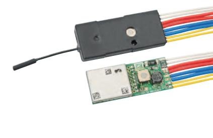
Niederdruck-Spritzguß – das optimale Verfahren, elektronische Bauteile zu umspritzen!
